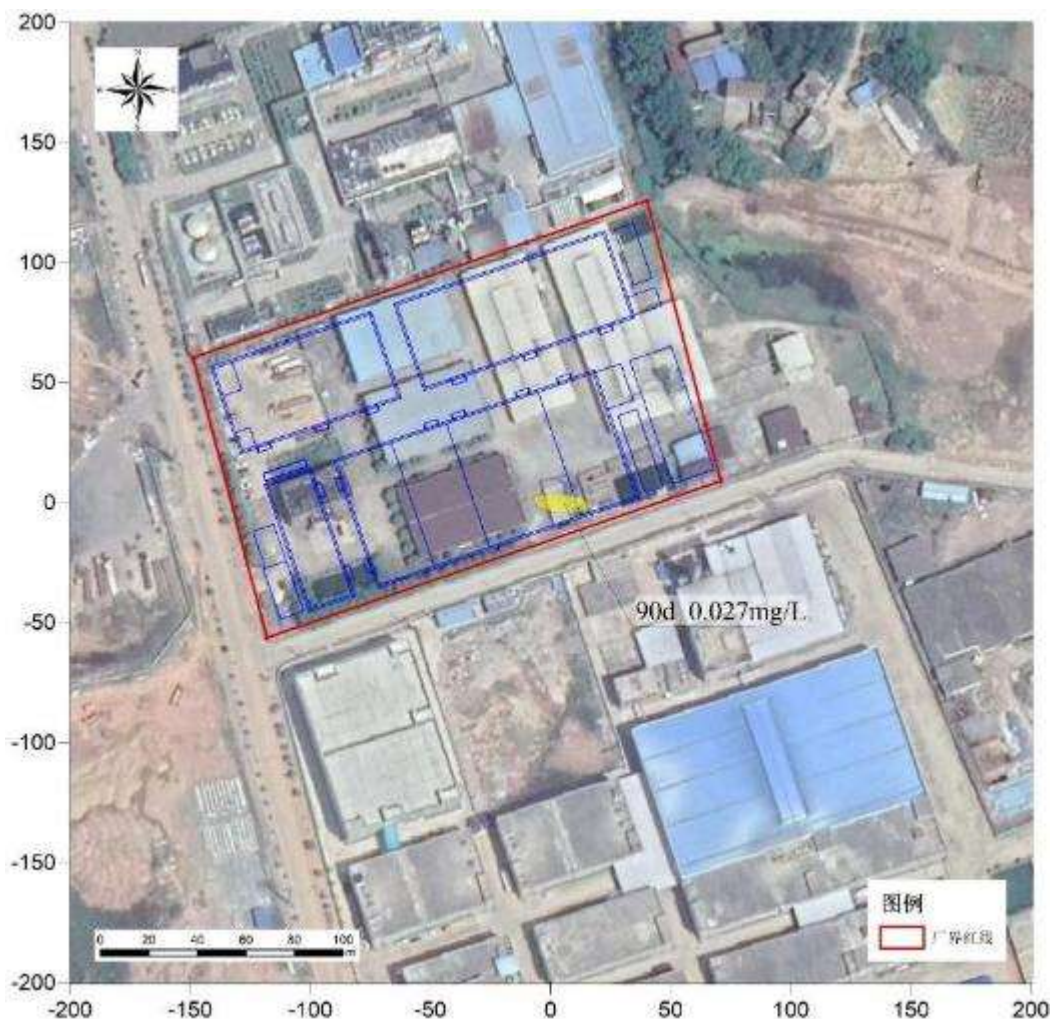
图5.3.5-2 物化调节池事故状况下镍超标范围及中心点浓度预测图
